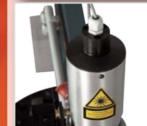
Цилиндр подготовлен для установки лазерного указателя
