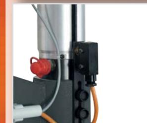
Цилиндр подготовлен для установки лазерного указателя
