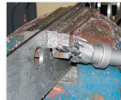
Ручное сверление до Ø 30 мм
