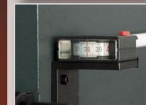
Размерная индикация по оси Y (Цифровая индикация - опция)
