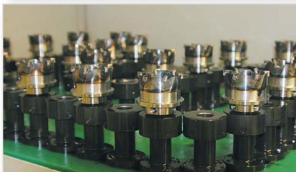
Еще одна особенность: Ножовки  $\varnothing$  от 15,2 мм до 30,0 мм - монолитные. Во избежание преждевременной деформации и скручивания стержня при высоких нагрузках начиная с  $\varnothing 31.0$  мм используются специально закаленные державки.
